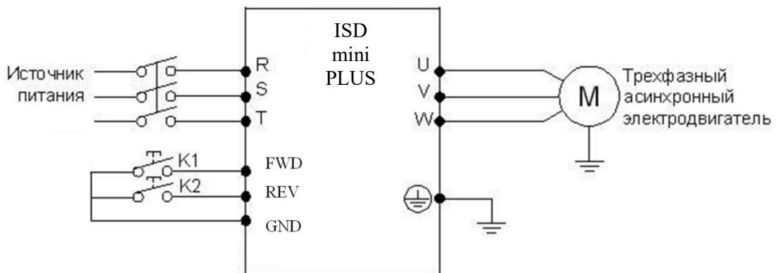
Пример работы преобразователя: Pb02=1, Pd15=6, Pd16=7, Pd29=0
