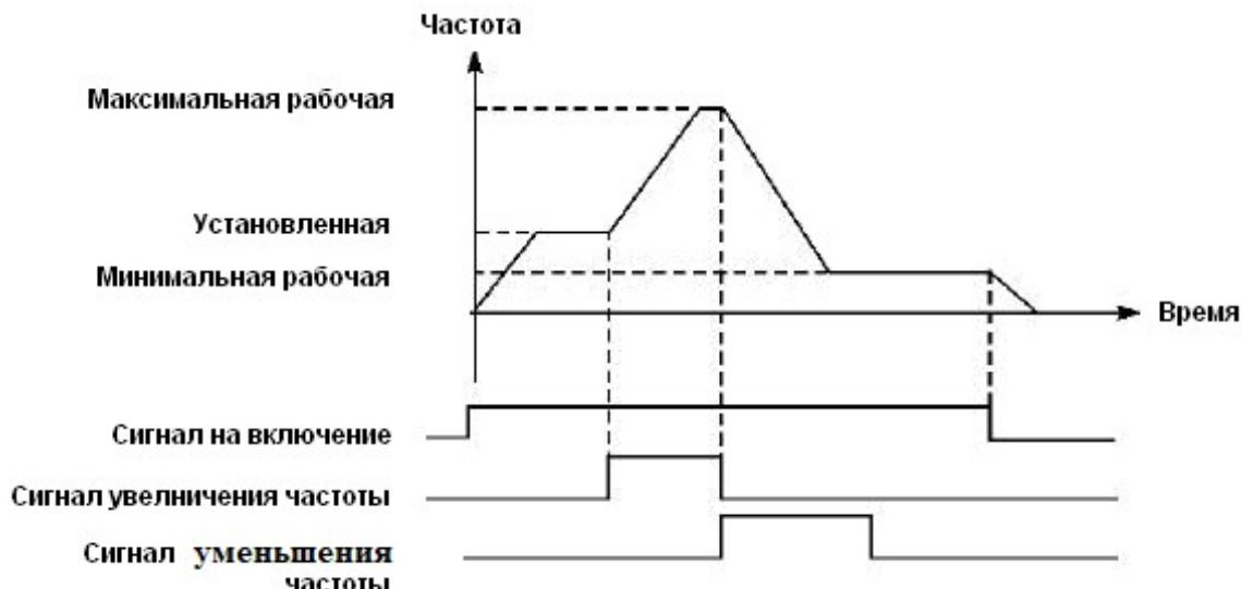
Внимание: по умолчанию заданная частота, установленная с помощью команд «UP» и «DOWN» не будет сохранена в памяти после выключения ПЧ, и при последующем запуске частота будет установлена в соответствии со значением параметра Pb00. (См. также Pi12)
