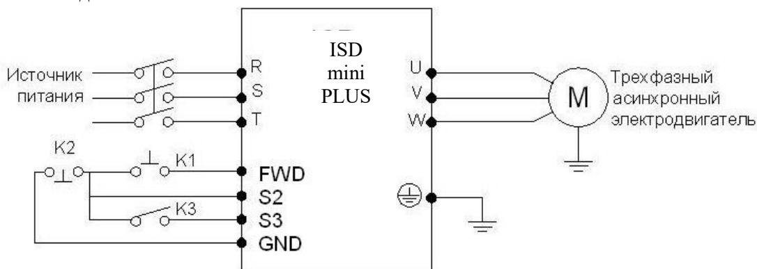
(2) Настройка параметра PF33 определяющего направления вращения
