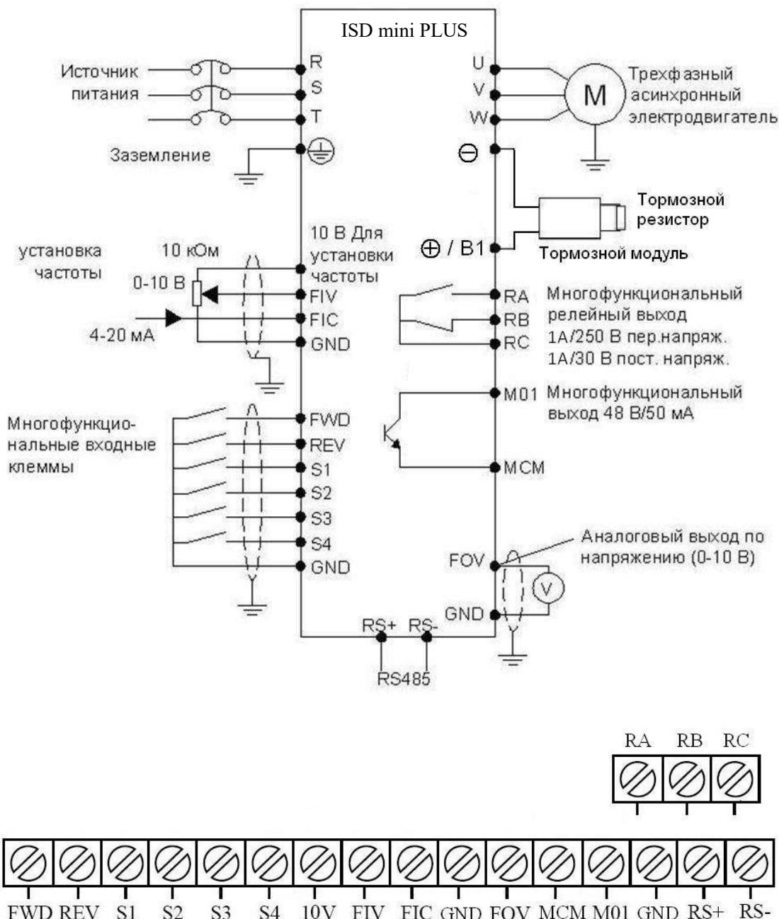
Момент затяжки винтов на клеммах - 0.2 Нм.
