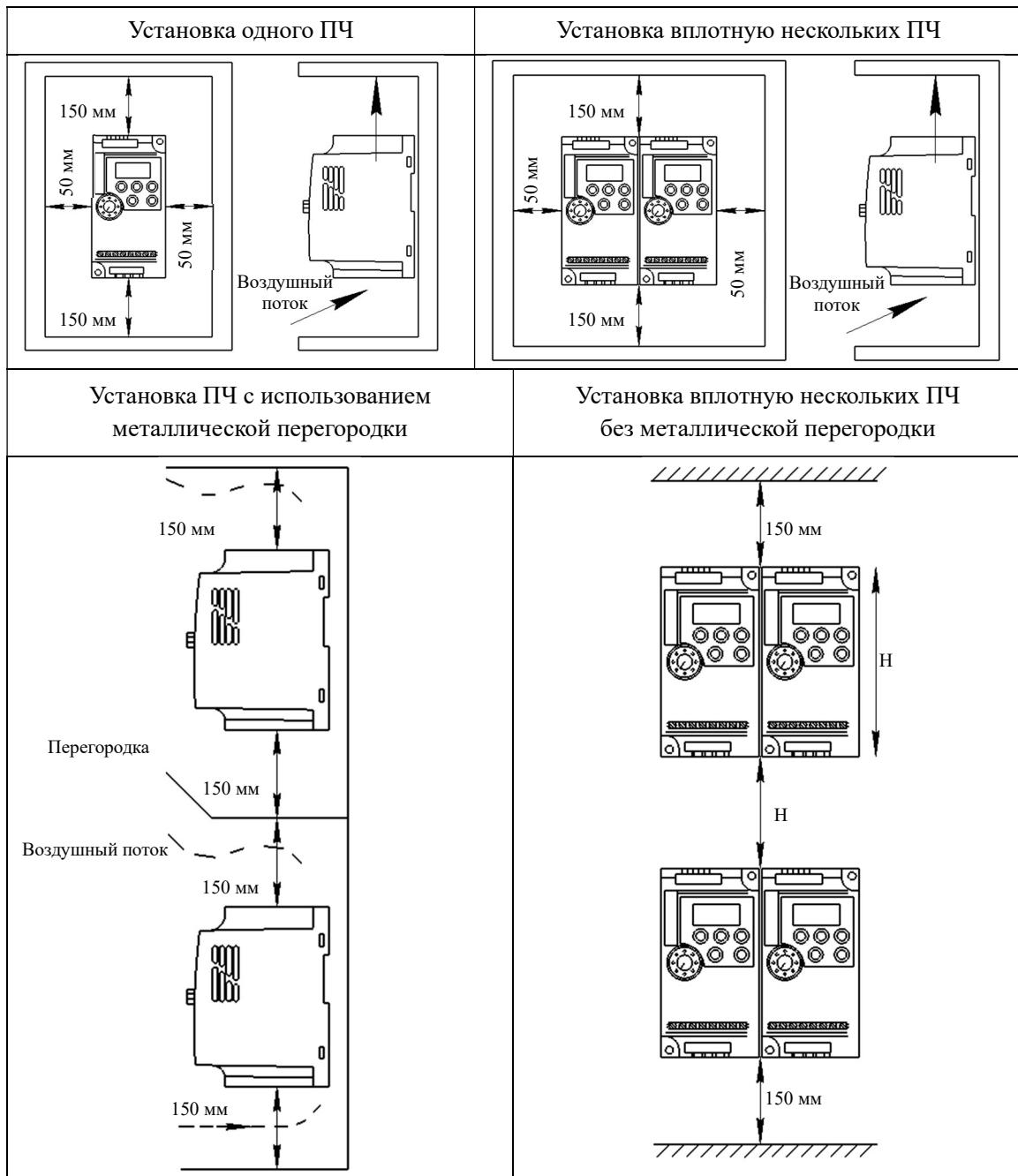
Перед монтажом нескольких ПЧ в один шкаф управления убедитесь, что в нем достаточно свободного пространства, имеется хороший теплообмен (температура внутри шкафа не должна превышать +40°C). Если ПЧ установлены рядом друг с другом, то расстояние между преобразователями должно быть больше 50 мм (разрешается устанавливать ПЧ мощностью до 11 кВт включительно вплотную.)
