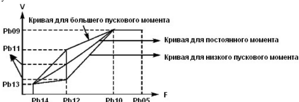
Форма V/F-кривой ПЧ задается с помощью группы параметров Pb09- Pb14. Различной нагрузке соответствуют различные V/F-кривые.
