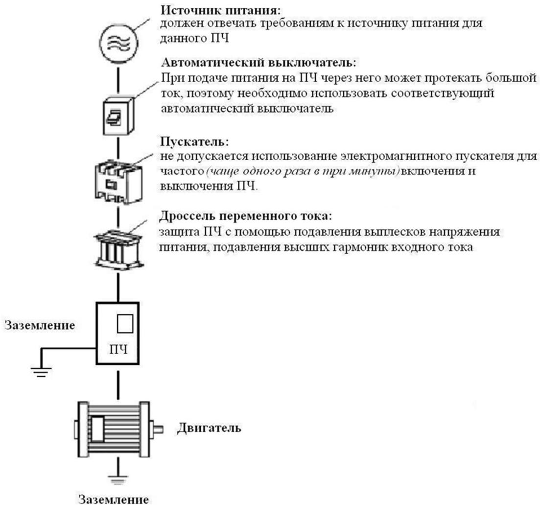
**⚠️ Подключение проводов питания следует производить только к входным клеммам преобразователя L1, L2, L3 для трёхфазного напряжения и L1, L2 для однофазного напряжения. В противном случае преобразователь может выйти из строя**
