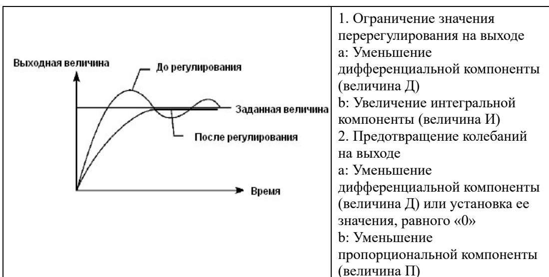
При использовании только П – закона регулирования возможна установившаяся ошибка регулирования с величиной до  $\pm 10\%$  от значения максимального сигнала обратной связи. Допустимая ошибка определяется величиной параметра PG20.
