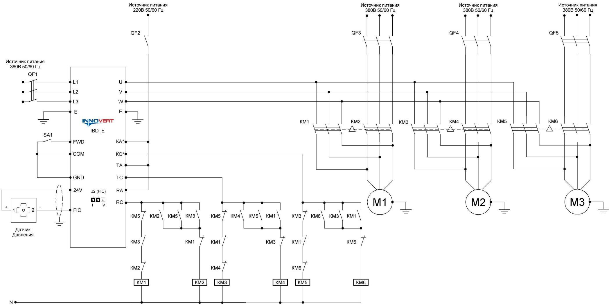
\* - Для подключения третьего насоса требуется наличие дополнительной платы с релейным выходом
