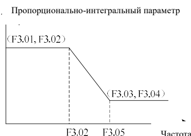
Рис. 6-7 Схема пропорционально-интегральных параметров контура скорости
