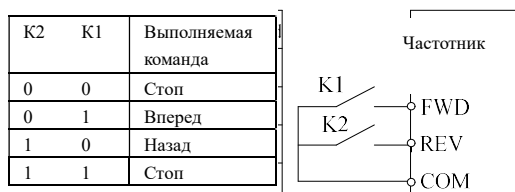
Рис.6-13 Двухпроводной режим управления 1
