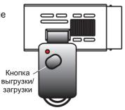
Устройство КЕҮ имеют встроенный элемент питания. Для длительного срока службы необходимо отсоединить устройство от термоконтроллера после процесса передачи.
