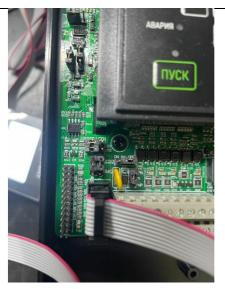
5. Подать напряжение питания на преобразователь частоты IBD\_E.
