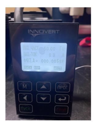
Предназначена для крепления на шкафах (щитах) управления IP31/IP54, настройки и отображения информации без непосредственного постоянного доступа к преобразователю частоты во время его работы.
