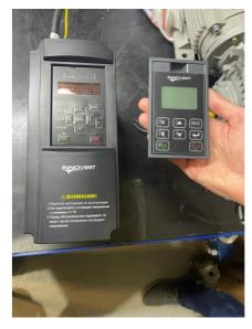
2. Подключить разъем кабеля выносной панели управления H06KP (разъем черного цвета) к разъему на плате управления (разъем черного цвета) преобразователя частоты IBD\_E.
