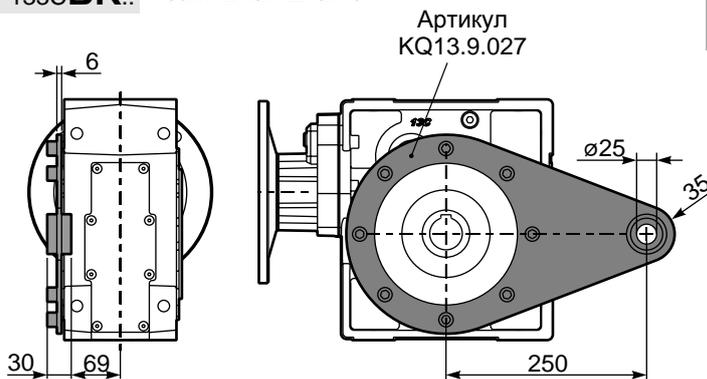
**P133C..A..** Односторонний выходной вал
