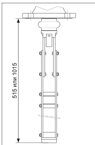
**3.2.3 Размеры для высокотемпературной версии (до +230°C)**
