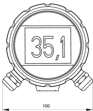
Корпус FlexHousing, поставляется с сенсорным экраном DFON или без него
