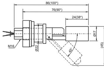
\* - Размеры для исполнений датчиков с поплавком из PVDF
