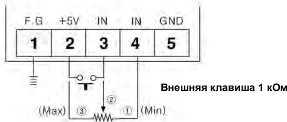
Пример 2) Показывает, как осуществить регулирование в диапазоне от 0 до 100% в режимах фазного и циклического регулирования без использования внешней клавиши. Это возможно при помощи клавиши OUT ADJ, при соединенных клеммах 2 и 3.
