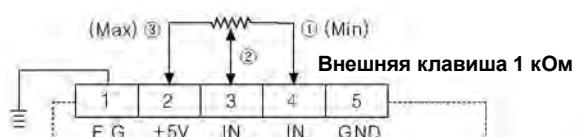
\* Возможно регулировать выходной сигнал при помощи функции Out ADJ, согласно описанной выше методике.
