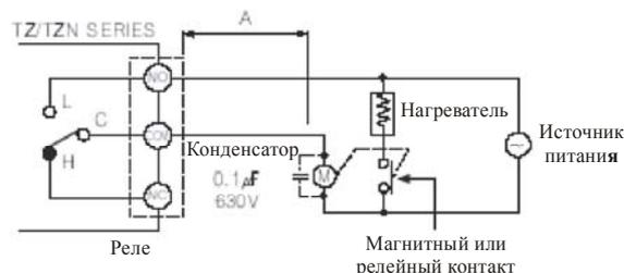
Источник питания реле должен быть расположен как можно дальше от TZ/TZN контроллера. Если длина провода А недостаточна, то токи намагничивания, возникающие в обмотках катушки могут вызвать сбой в работе прибора. Если недостаточна длина провода, подсоедините майларный конденсатор 0,1мФ (104 630В) через катушку реле "M" для защиты от намагничивания.
