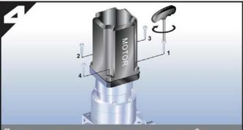
Произведите монтаж в вертикальном положении. Закрутите монтажные винты (вместе с шайбами) в порядке, указанном на рисунке, при помощи ключа до значений, составляющих 5% от моментов, указанных в таблице 1.
