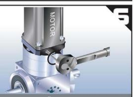
Закрутите установочный винт при помощи специального гаечного ключа до момента затяжки, указанного в таблице 2.
