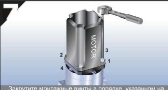
Закрутите монтажные винты в порядке, указанном на рисунке. При помощи специального гаечного ключа закрутите винты до моментов затяжки, указанных в таблице 1.
