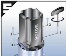
Произведите монтаж в вертикальном положении. Закрутите монтажные винты (вместе с шайбами) в порядке, указанном на рисунке, при помощи ключа до значений, составляющих 5% от моментов, указанных в таблице 1
