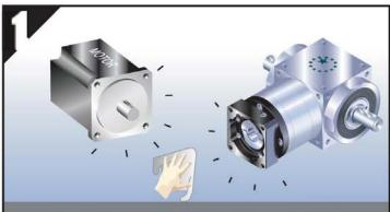
Проверьте (дважды) типоразмеры двигателя и редуктора. Очистите монтажные поверхности.
