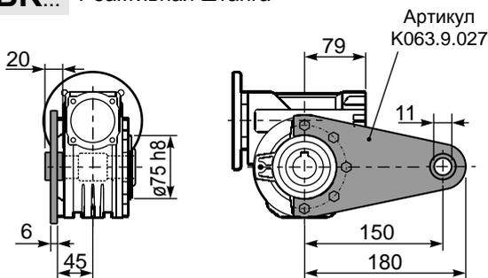
**Р063.....S...** Односторонний выходной вал
